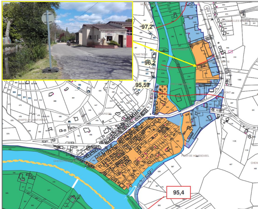
PPR Inondation Bassin du Lot Aval-Vert-Masse - Commune de Castelfranc Plan de Zonage (source : DDT 46) Localisation de la caserne de Castelfranc au bord du ruisseau du Vert en zone orange (source : SMBL)
